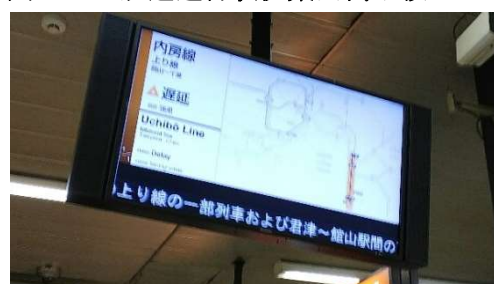
図 2-12 鉄道運行状況案内掲示板
